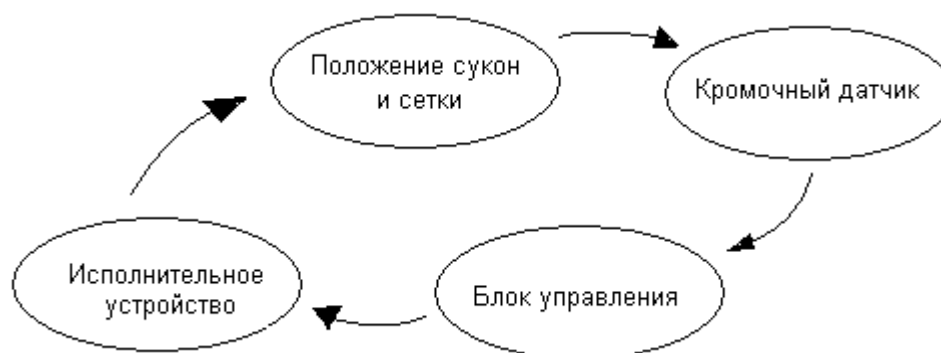
Рис. 1. Принципиальная схема управления правкой сетки или полотна
