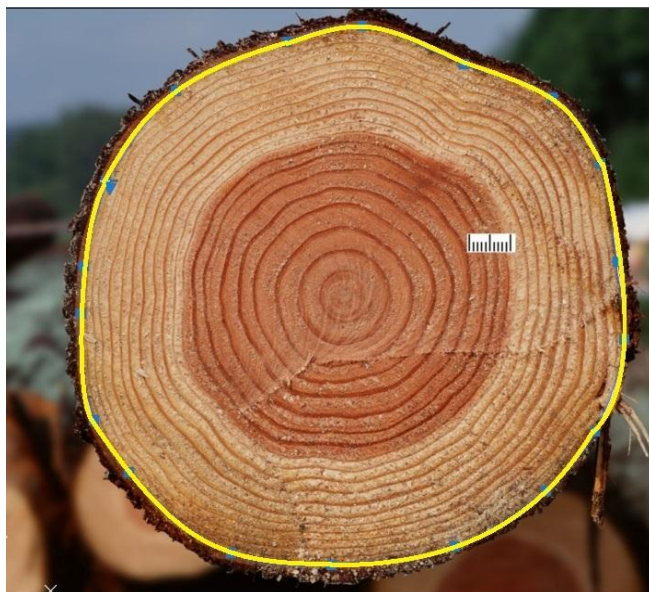
Рис. 1. Пример создания модели поперечного сечения бревна по фотоизображению в программе AutoCAD
