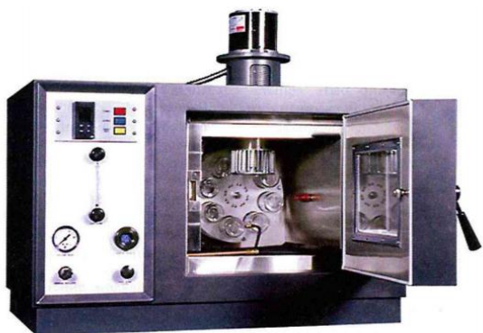
Рис. 1. Тонкопленочная печь (RTFO) для искусственного старения вяжущего в процессе приготовления и укладки асфальтобетонной смеси (температура 163 °С в течение 85 мин)
