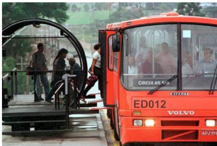
Пример остановочного пункта, оборудованного откидными трапами
