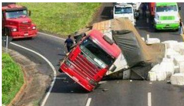
Опрокидывание грузового автотранспортного средства при смещении центра масс груза (при перегрузе)
