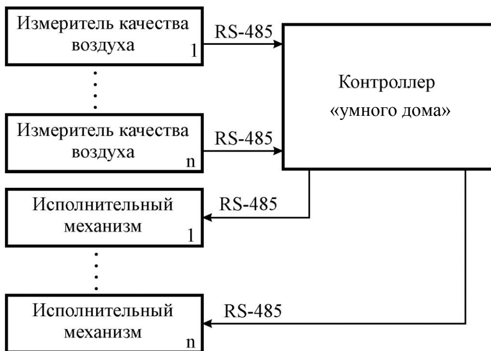
Рис. 2. Структурная схема системы «умный дом»
