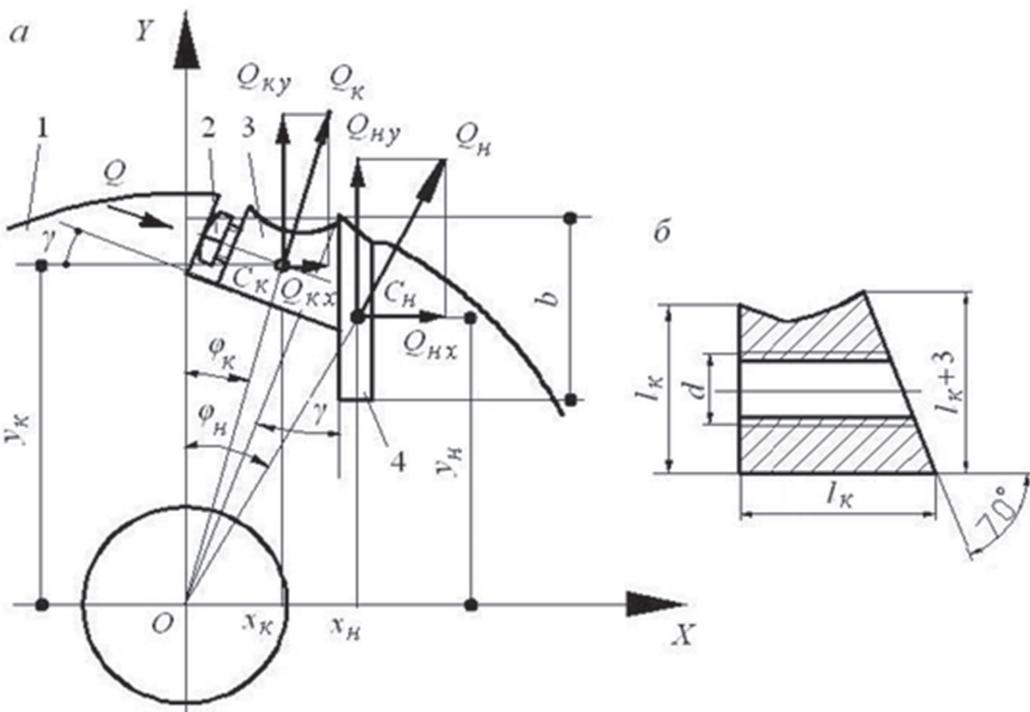
Схема к расчету клинового крепления ножа:
