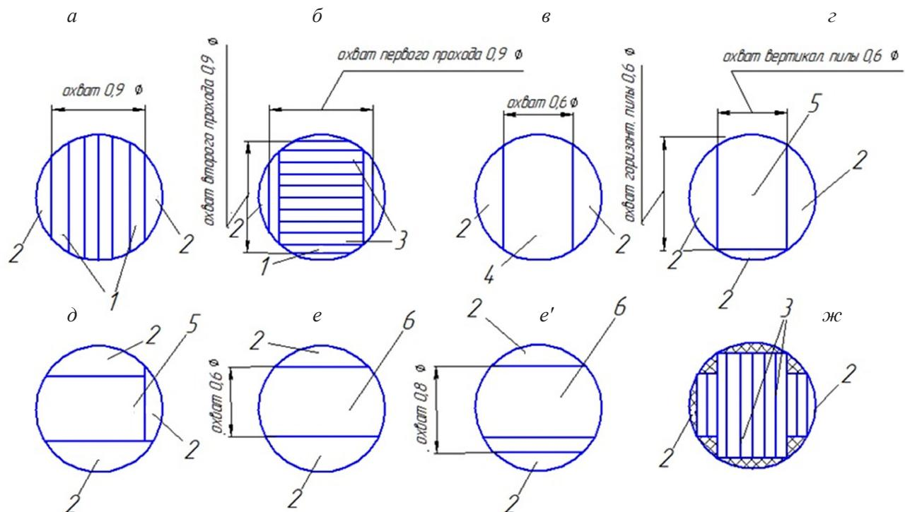
Рис. 1. Влияние способа раскroя и величины охвата поставом вершинного диаметра бревна на размеры и количество горбылей (на примере переработки круглого лесоматериала диаметром 26 см, пиловочника длиной 6 м и шпального кряжа 5,5 м):
